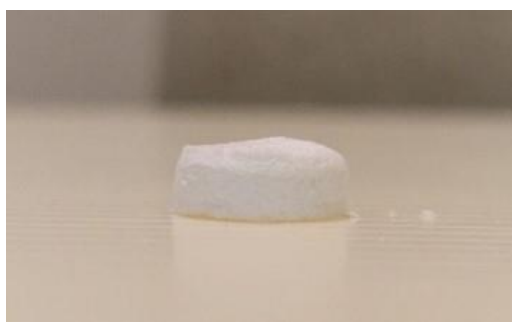
圖 21. 膠原蛋白與羥基磷灰石所複合形成的人工骨軟骨移植物。利用材料工程方式模擬骨組織之組成與結構，可促進骨細胞之分化與生長。
