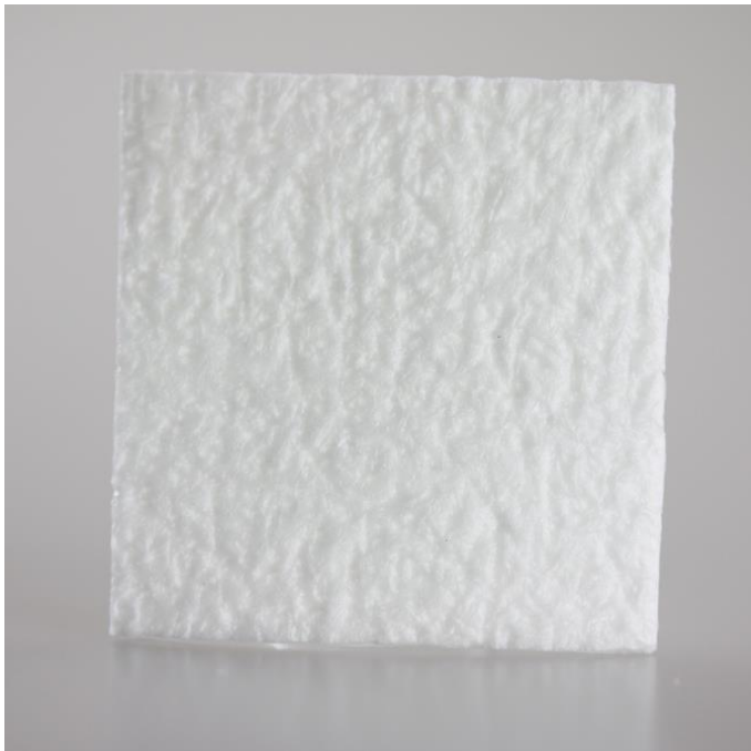
圖 18. 膠原蛋白傷口敷料。研究人員常利用凍乾製程製造出如同海綿般鬆散具孔洞的結構的膠原蛋白。 [17]
