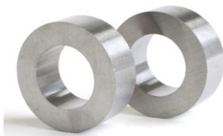
圖 2 鋁鎳鈷合金。鋁鎳鈷合金為脆性，因此多半使用鑄造或粉末冶金的方式製造。(http://www.electronenergy.com/alnico-magnets/)
