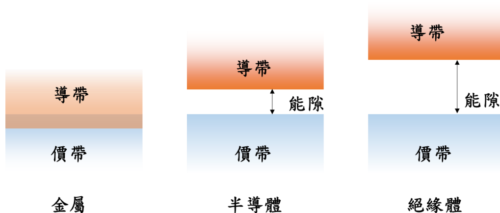
圖 6: 金屬、半導體與絕緣體之能帶架構示意圖。
